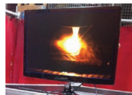
Nozzlefuse 624: Die eingebaute Kamera bietet eine Echtzeit-Sichtkontrolle des Auftrags („Cladding“)
