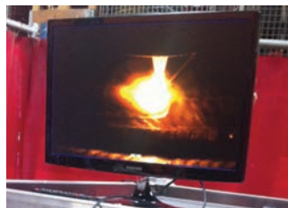
Nozzlefuse 624: La cámara integrada proporciona un control visual del recargue en tiempo real
