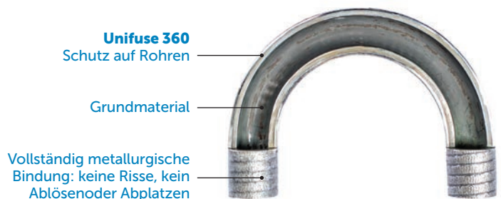
Querschnitt eines gebogenen Rohres
