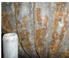
Corrosión en la cara expuesta al fuego de una caldera de carbón
