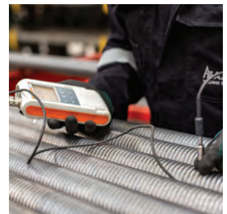
Control del espesor
