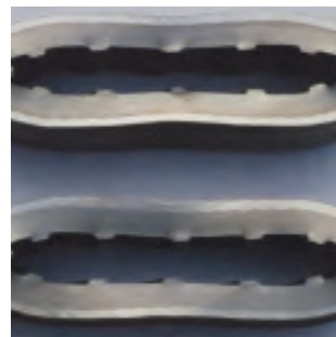
Ensayo de aplastamiento
