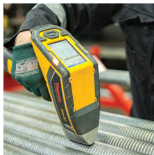
Analyse chimique du revêtement
