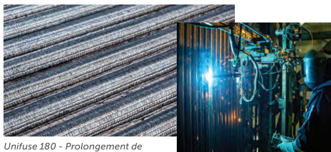
Unifuse 180 Rechargement de panneaux plats et droits
