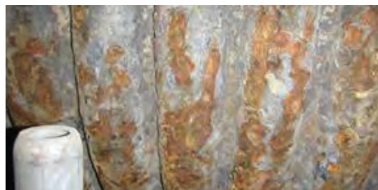
Corrosione lato fiamma in una caldaia a carbone
