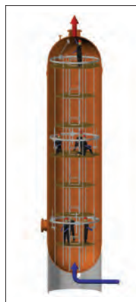
Gráfico sombreado de la contracción diametral prevista de la columna de vacío
