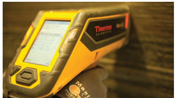
Inspección PMI/FN mediante XRF
