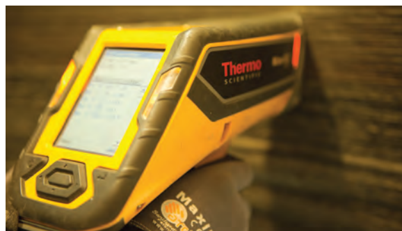
Ispezione PMI/FN mediante XRF
