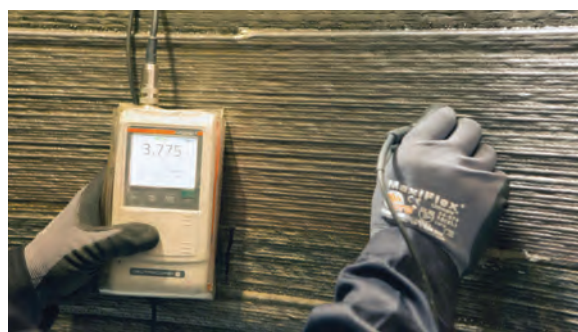
Letture UT dello spessore del rivestimento
