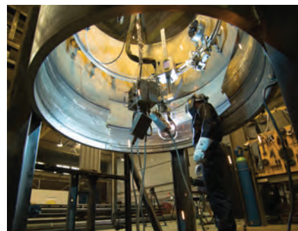
Mock-up per la saldatura di riporto automatico su superfici sferiche
